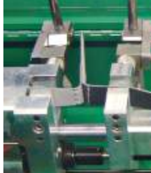
Испытание сварного шва при помощи EXAMO USB
